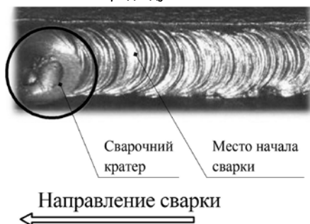
Рис. 9.2. Начало сварки при смене электрода.
