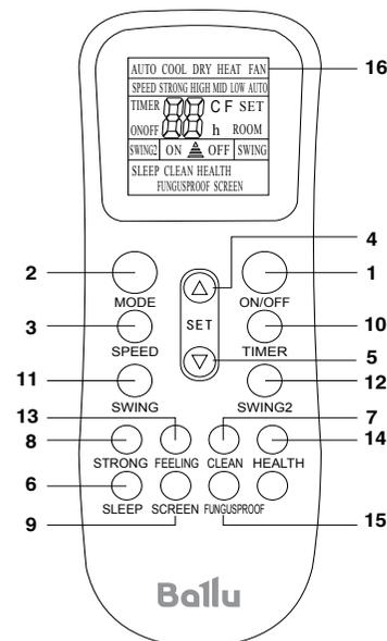
1. Кнопка ON/OFF – включение/выключение.
