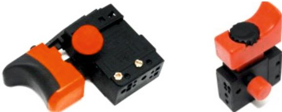
используется для запуска инструмента. Необходимо только нажать пальцем на клавишу, чем сильнее усилие нажатия на клавишу, тем быстрее скорость вращения инструмента. При отпускании клавиши, движение инструмента прекращается. На модели **PBM13-C** по центру клавиши включения расположено колесо регулировки скорости, им ограничивается максимальная скорость вращения инструмента.
