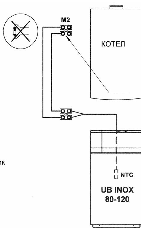
Рис. 4 Подсоединение датчика NTC приоритета контура ГВС
