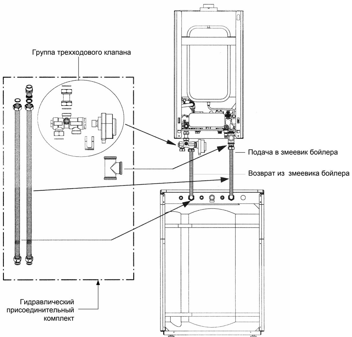
Рис.3Б Гидравлический присоединительный комплект - ECO 3 – ECO 4
