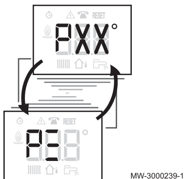
Рис.15 Доступ к меню режима "Трубочист"
