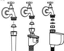
Закройте краны. Снимите гайки на заливных шлангах для доступа к фильтрам во впускных патрубках. Очистите их подходящей щеточкой. Если фильтры сильно загрязнены, их можно вытащить плоскогубцами и почистить. Извлеките фильтры из прямых концов
