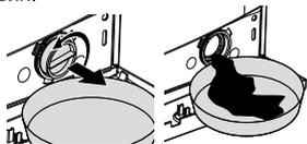
Поставьте перед фильтром вместительную емкость для слива воды. Понемногу поворачивайте фильтр насоса против часовой стрелки, пока не начнет выливаться вода. Слейте воду в установленную перед фильтром емкость. Всегда держите под рукой тряпку для сбора пролитой воды. Когда вода перестанет вытекать, полностью выверните фильтр и выньте его из машины.
