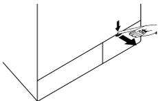
**i** Чтобы снять крышку фильтра, можно слегка прижать ее каким-либо инструментом с тонким пластиковым наконечником, вставив его в щель над крышкой. Не используйте для открывания крышки инструменты с металлическими наконечниками.
